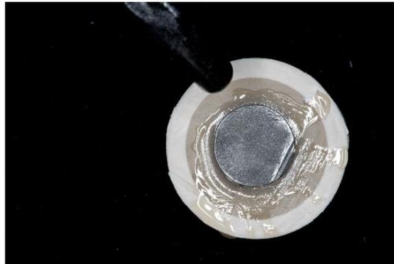
*Figura 5* Eliminación de exceso de adhesivo con corriente de aire.
