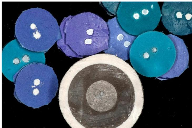
*Figura 15 Falla prematura de los especímenes de ionómero de vidrio.*
