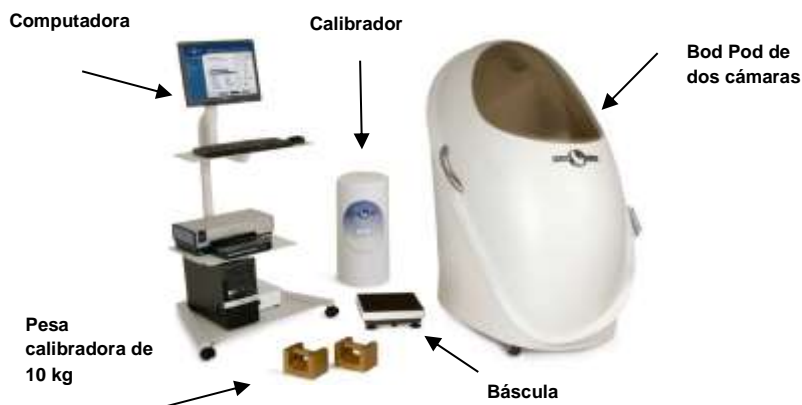
Figura 1. Equipo pletismografía por desplazamiento de aire "BOD POD". Fuente: Tecnomed, 2015.
