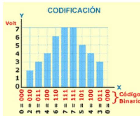
Fig.1.10 Codificación de una señal
