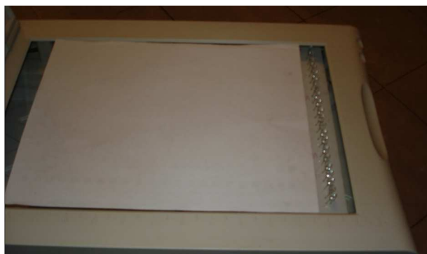
Figura 5.4 posición de los sensores ópticos.
