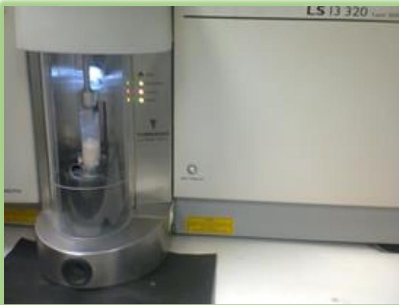
Figura 12. Analizador de tamaño de partícula por difracción de Laser LS13 320
