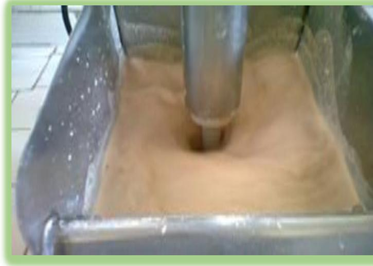
Figura 13. Celda Denver para realizar la atrición del caolín
