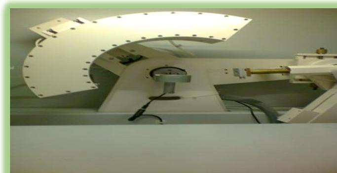
Figura 16. Difractómetro de rayos X.
