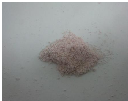
Figura 17. Imagen de los polvos obtenidos después de la operación de secado de la solución de extracto de xoconostle con goma arábica y maltodextrina (50:50)
