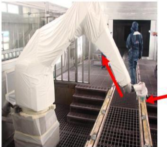
7.-Se coloca la parte más amplia de la funda hacia en cuerpo del robot y la pequeña en la punta.
