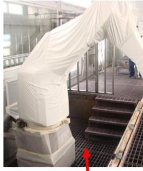
5.-Colocar fundas a un lado de robot.
