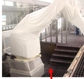
5.-Colocar fundas a un lado de robot.
