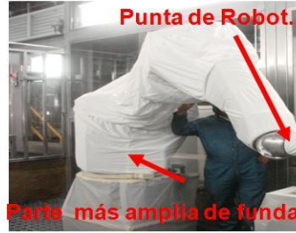
6.-La Parte más amplia de funda se introduce de la punta del robot hacia la base de este.
