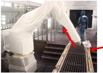
7.-Se coloca la parte más amplia de la funda hacia en cuerpo del robot y la pequeña en la punta.
