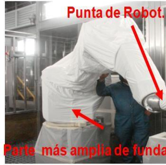
6.-La Parte más amplia de funda se introduce de la punta del robot hacia la base de este.
