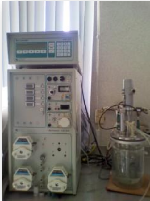
Figura 4. Fermentador autoclavable de 3L Applikon Z61103CT04 y bioconsola ADI 1030 (Laboratorio de Biotecnología, ICAp, UAEH).
