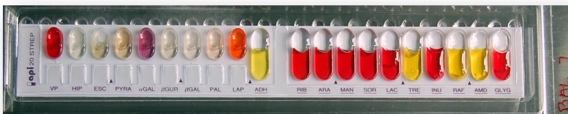
Figura 10. Detección de actividad enzimática o fermentación de azúcares en sistema API 20 Strep, compuesto por 20 microtubos.
