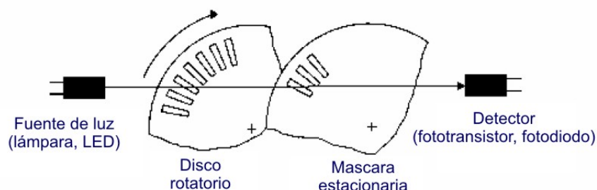
Figura 4.8: Decodificador incremental óptico.
