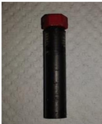
Figura 27. Electrodo composite PC-NTCMP. Se empleó una proporción de 70% de polvo de grafito y 30% de NTCMP.
