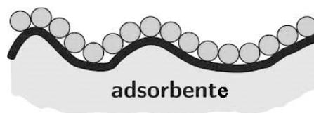
**Figura 4.** Cobertura de monocapa del sorbato sobre la superficie del sorbente: Modelo de Langmuir
