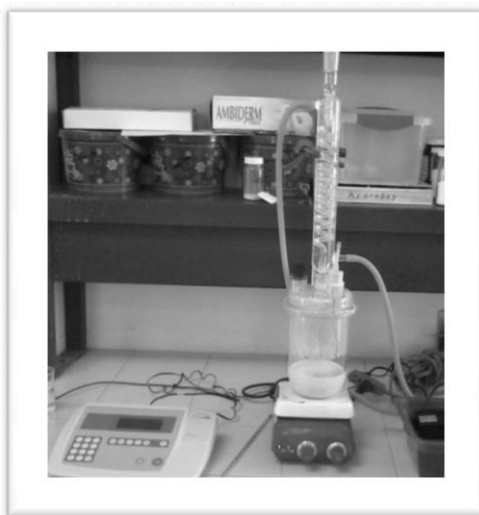
Figura III.4. Dispositivo experimental del estudio de la lixiviación de arcillas caoliníticas.
