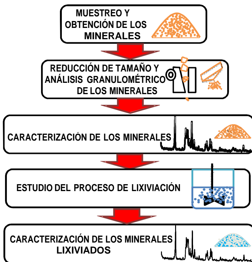
Figura III.2. Metodología experimental general del estudio del blanqueo de arcillas caoliníticas por medio de lixiviación.
