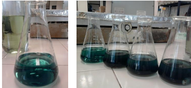
Figura 25. Determinación de materia orgánica del suelo por el método Walkley y Black.
