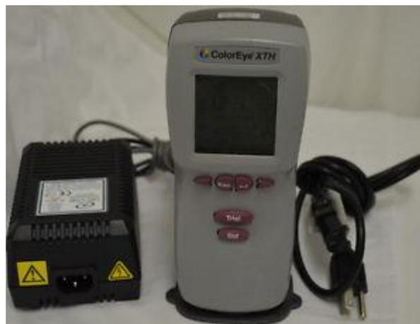
Figura 13. Espectrofotómetro marca Gretag Macbeth, modelo ColorEye® XTS.
