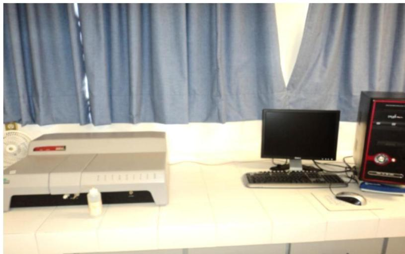
Figura 9. Equipo de potencial Z marca Malvern, modelo 3000 HSA.
