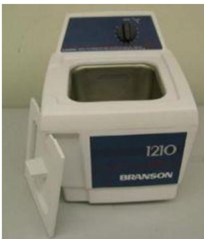
Figura 16. Baño ultrasónico utilizado durante el tratamiento.
