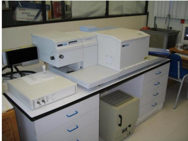
Figura 8. Espectrofotómetro FTIR marca Perkin-Elmer, modelo Spectrum GX®
