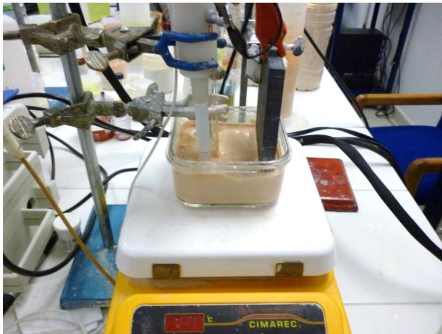
*Figura 51. Celda electroquímica de 250ml*
