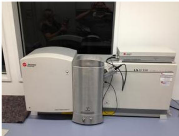
*Figura 14. Analizador de tamaño de partícula por difracción de rayo láser marca Beckman Coulter, modelo LS13320*
