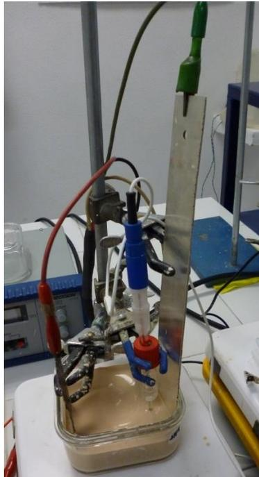
*Figura 36. Celda electroquímica con arreglo típico de 3 electrodos sobre la cual se realizó el tratamiento de macroelectrólisis por 24 horas.*
