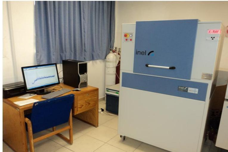
Figura 12. Equipo de XRD marca Inel Modelo Equinox 2000.
