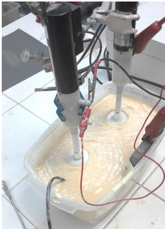
*Figura 53. Celda electroquímica de 2500ml.*
