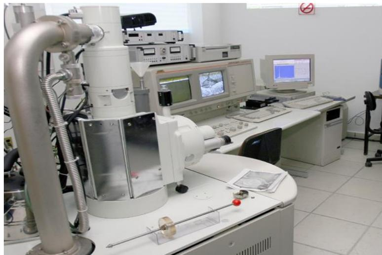
*Figura 10. Microscopio electrónico de barrido marca JEOL modelo 6300.*
