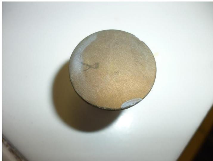
*Figura 55. Electrodo de 23 mm de diámetro en el cual se observa un depósito después del tratamiento electroquímico en la arcilla de caolín.*
