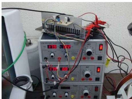
Figura 2.3: Circuito amplificador y sistema de fuentes.
