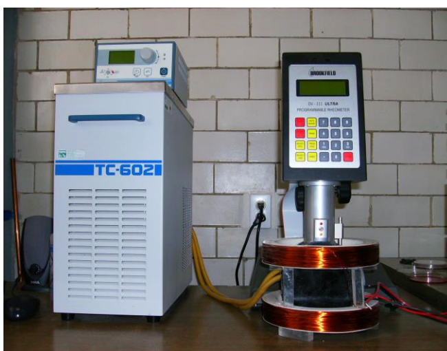
Fig. 2.5 Sistema de reometría (fuente: propia)
