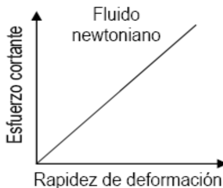
Grafica 1.2.1 comportamiento de fluidos newtonianos. (fuente: http://polaris.esfm.ipn.mx/~labfisica3/practfis/fis2/viscosi.pdf )
