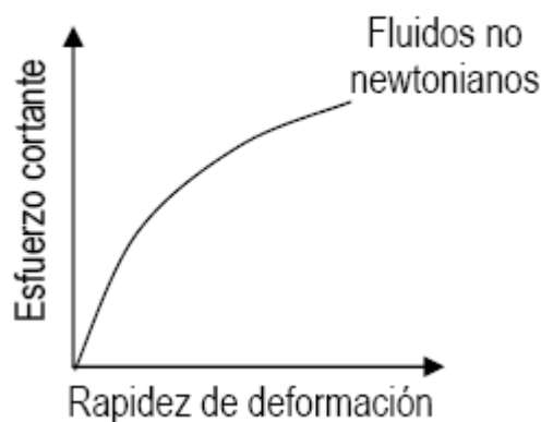
Grafica 1.2.2 Comportamiento de los fluidos no newtonianos (Fuente: http://polaris.esfm.ipn.mx/~labfisica3/practfis/fis2/viscosi.pdf )
