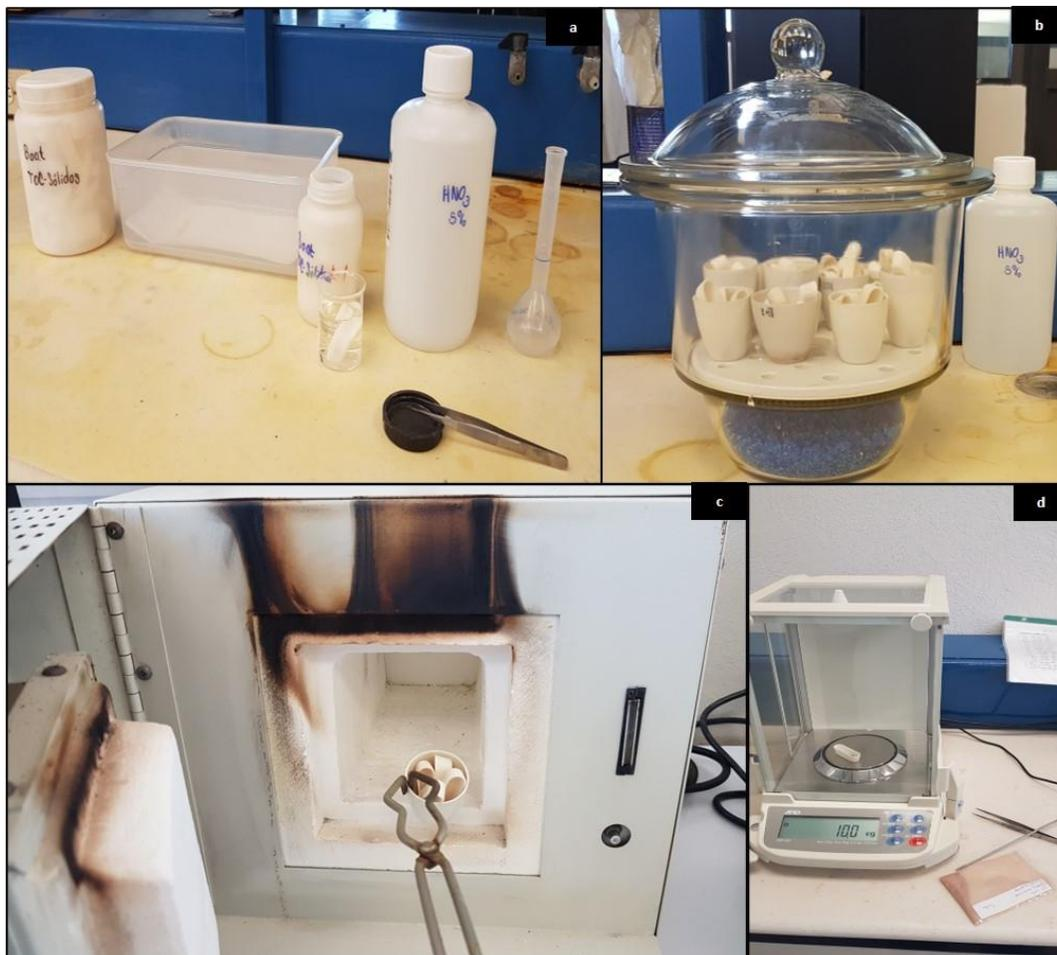
**Figura 8.** Preparación de muestras individuales, donde a). esterilización de boats con ácido nítrico, b). desecador de cristal con vacío, c), secado en Mufla y d). peso de muestra en balanza analítica.
