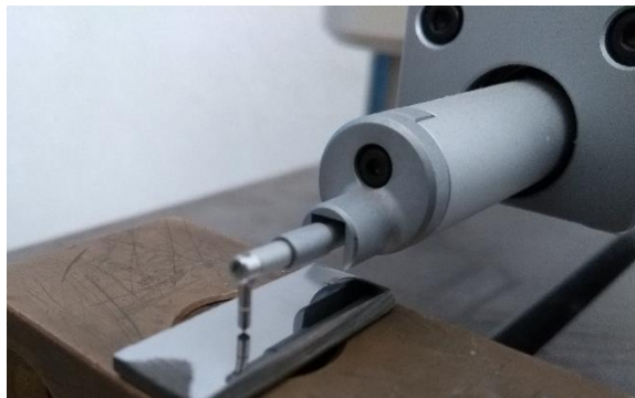
Figura 30. Punta palpadora del rugosímetro sobre una muestra.
