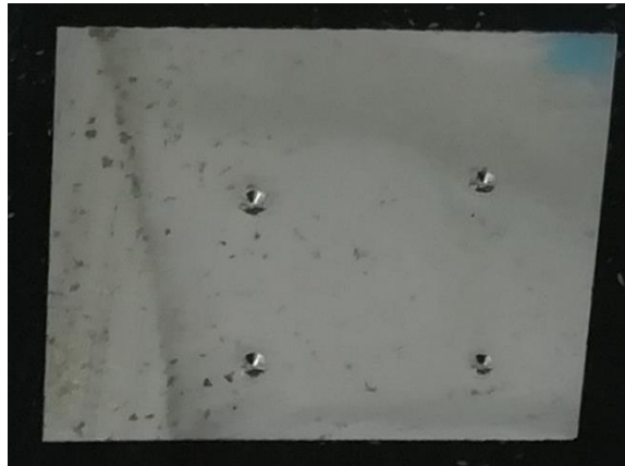
Figura 37. Probeta con huella después del ensayo Rockwell.
