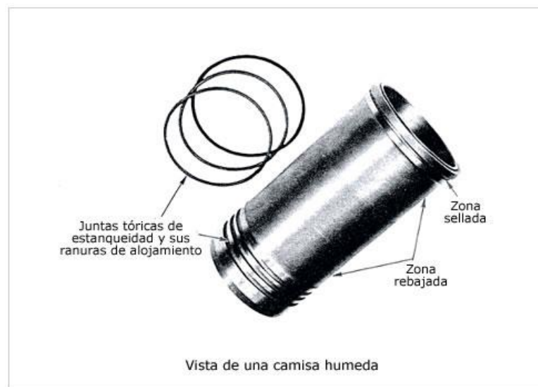
Figura 14. Vista de una camisa húmeda. Imagen recuperada de https://ingenieromarino.com/las-camisas-y-su-disposicion-en-el-bloque-motor/
