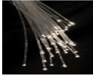
Fig.2.4.2 Los cables de fibra óptica proporcionan una alternativa a los gruesos cables de hilo de cobre en la Industria de las telecomunicaciones. Un único par de cables ópticos de transmisión de luz puede soportar
