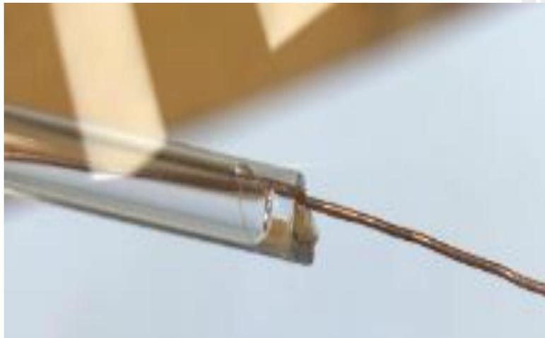
Figura 3.4. Sellado del electrodo con resina epóxica.
