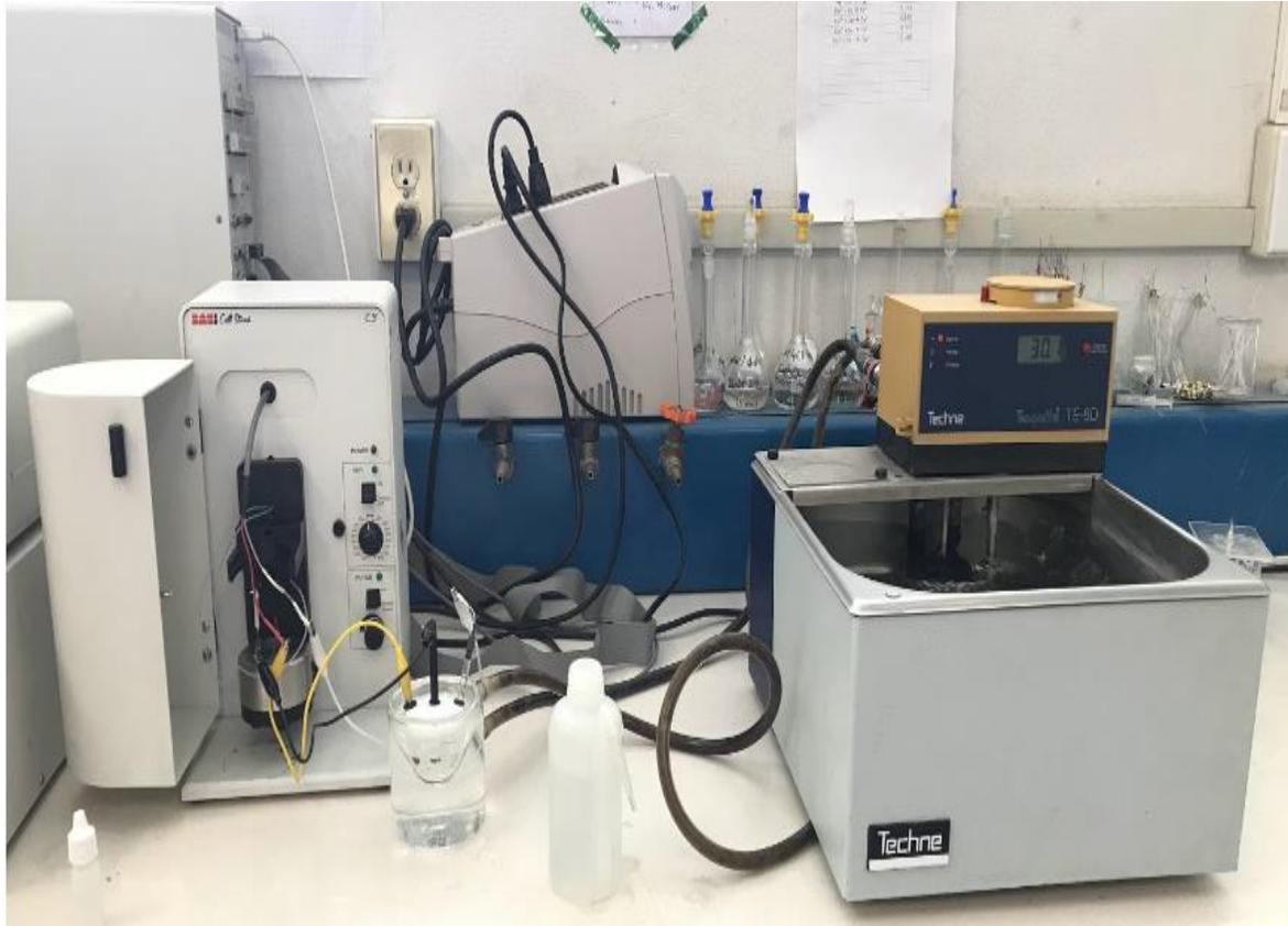
**Figura 3.7.** Control de temperatura. Controlador de temperatura Techne Tempette TE-8D.
