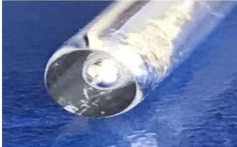
Figura 3.5. Desbaste del electrodo hasta obtener un acabado espejo.
