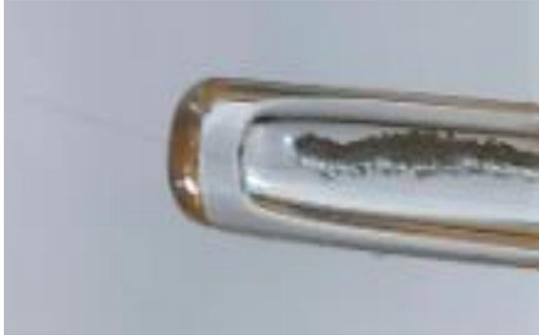
Figura 3.3. Adhesión del metal con pasta conductora de plata.
