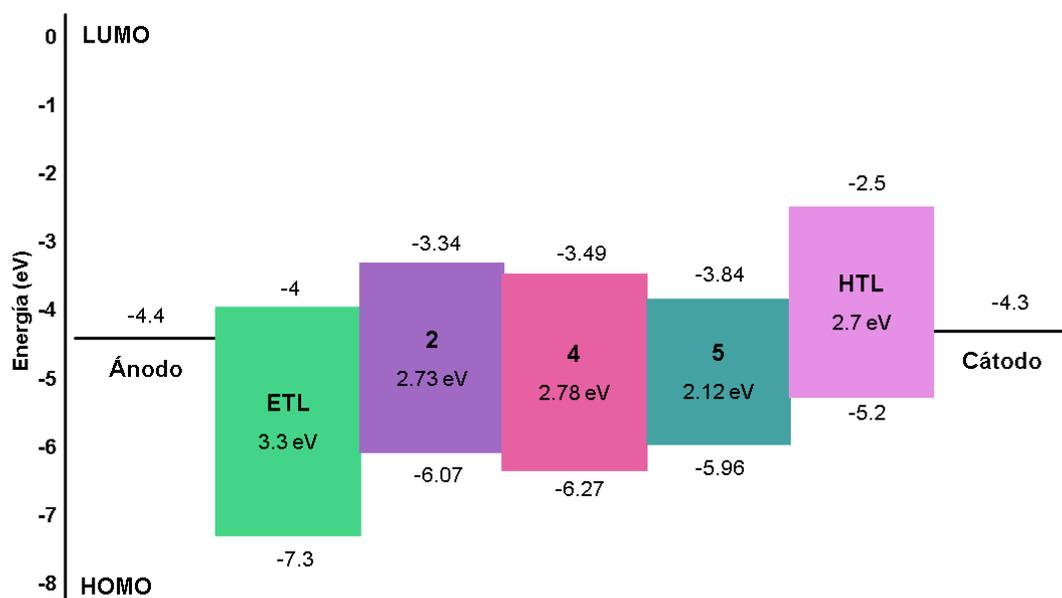
**Figura 41.** Diagrama de los niveles de energía de un dispositivo optoelectrónico con los complejos **2**, **4** y **5**.
