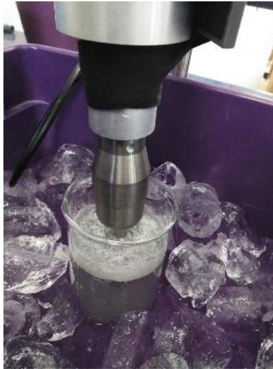
**Figura 27.** Imagen del proceso de lixiviación asistida con ultrasonido.
