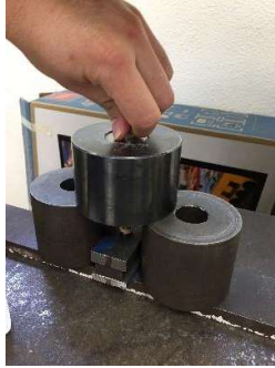
Figura 3.9 Macrofoto montaje de polvos compósitos en el dado de la prensa hidráulica.
