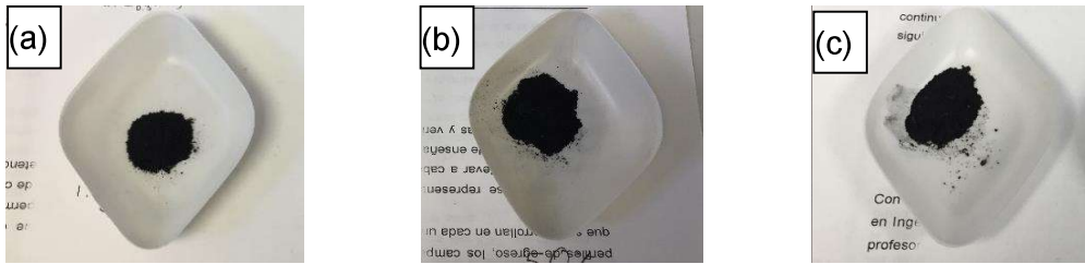
Figura 4.12. Macrofotos de polvos bifásicos de diferente composición: (a) 75LCM-25LCSM, (b) 50LCM-50LCSM y (c) 25LCM-75LCSM.
