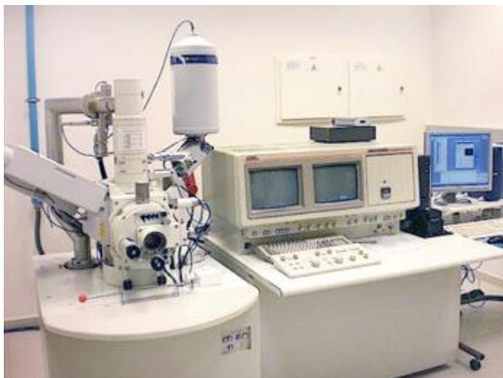
Figura 3.9 Microscopio electrónico de barrido.
