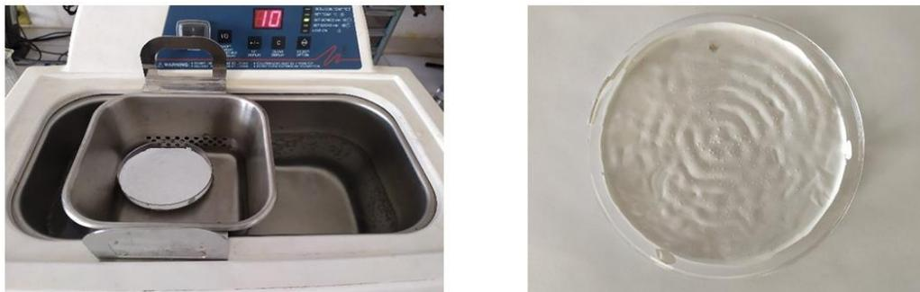
Figura 3.14 Uso de ultrasonido para la preparación de las membranas.
