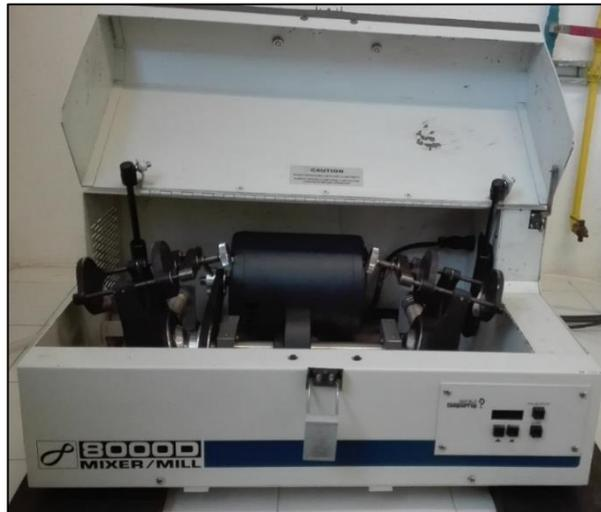
Figura 3.4 Molino mecánico de alta energía.
