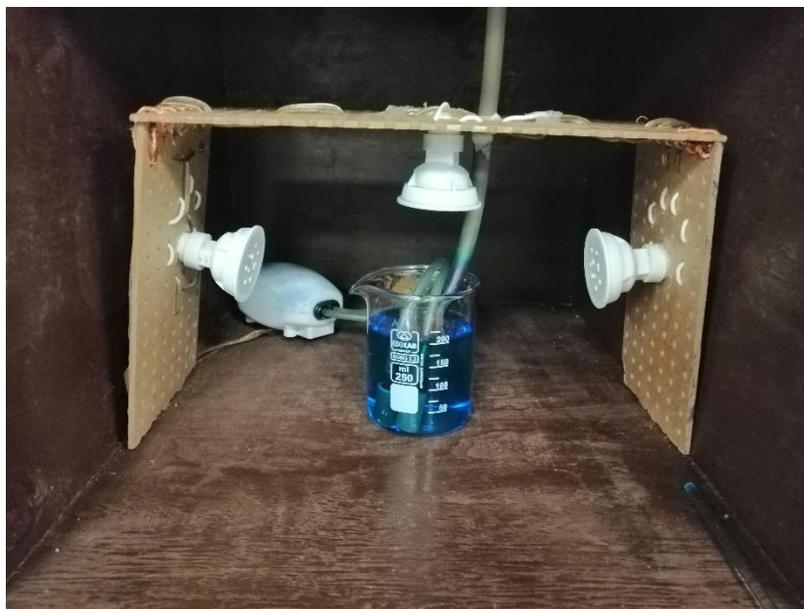
*Figura 4.9 Equipo de caracterización del comportamiento fotocatalítico.*
