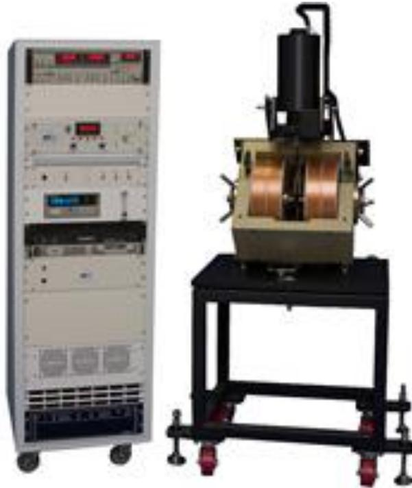
*Figura 3.6 Magnetómetro de muestra vibrante.*
