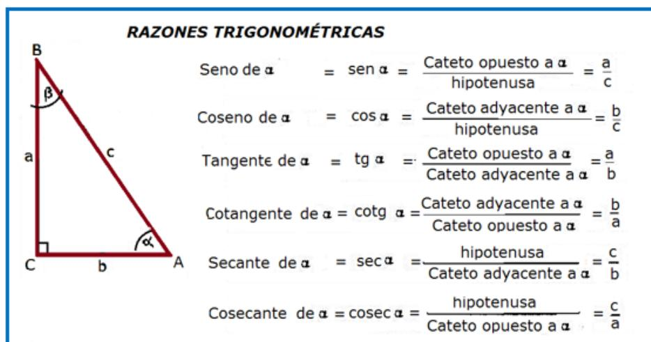
Figura 3. Razones trigonométricas en el triángulo rectángulo.
