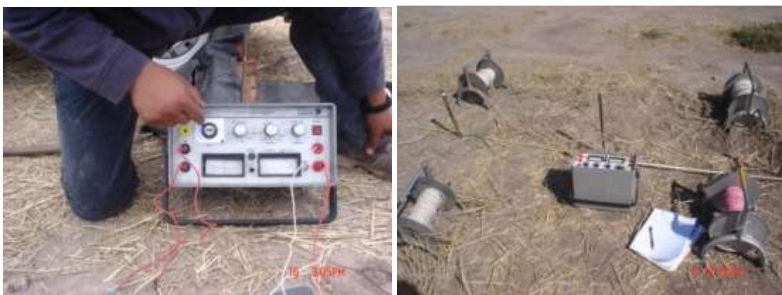
Figura 5.1. Equipo BISON-2350B usado en campo.
