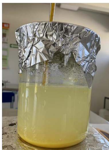
Figura 16. Sedimentación de polvos de solución final \text{SnO}_2 : In antes de ser ingresados al refrigerador.
