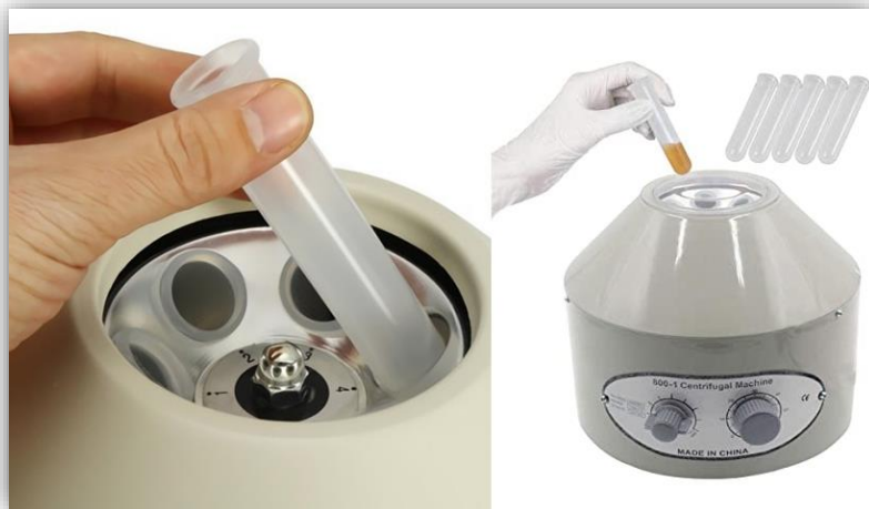
Figura 19. Colocación de los 6 tubos en la maquina centrifuga de laboratorio. Fotografía propia.
