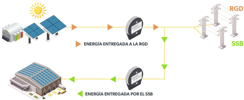
Figura 4.20 Esquema Net Billing o Facturación Neta
