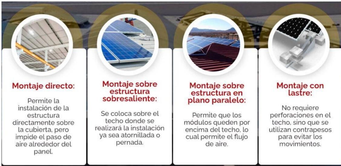
Figura 4.17 estructuras sobre techo.
