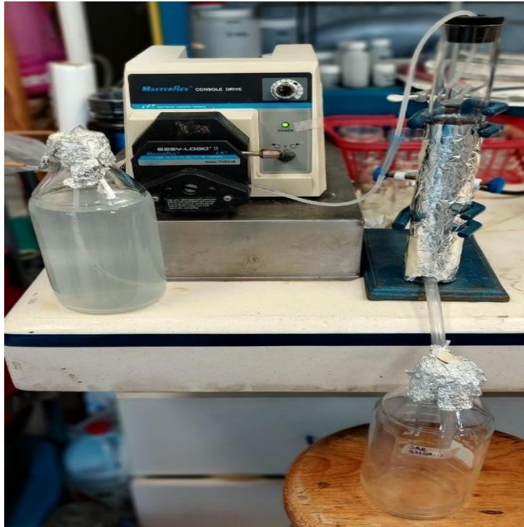
Figura 7.6. Montaje de la columna de lecho empacada alimentada con agua gris real.
