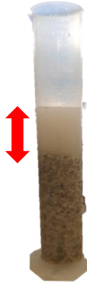
Figura 7.5. Probeta con zeolita y agua utilizada para medir el volumen de poro.
