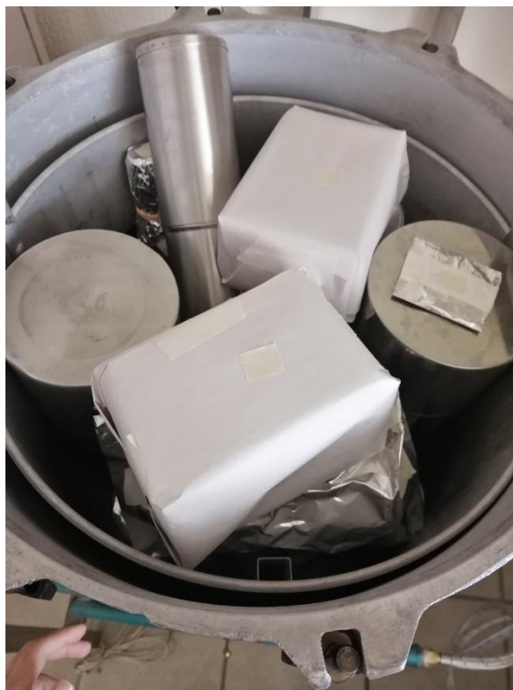
Figura 7.7 Material dentro de la autoclave antes de ser esterilizado.
