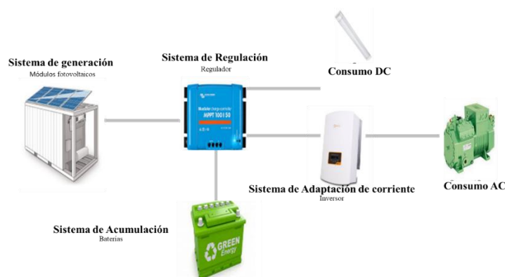
Figura 2.6 Esquema general de un sistema fotovoltaico (Elaboración propia).
