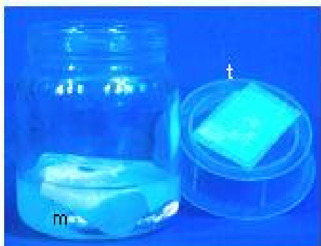
Figura 4. Sistema de aclimatización in vitro . m, medio líquido con puentes de papel filtro; t, tapas perforadas y selladas con cinta Micropore®
