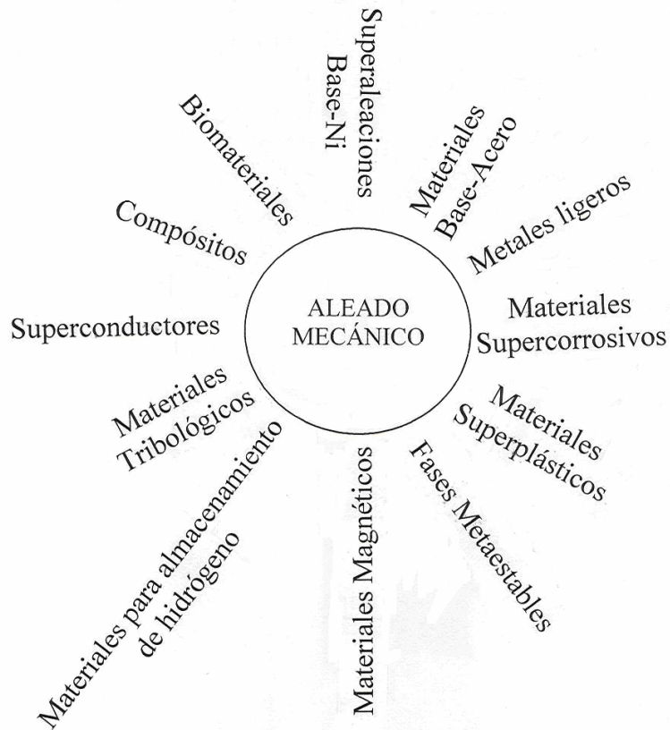
Fig. 1.1. Áreas de aplicación del AM
