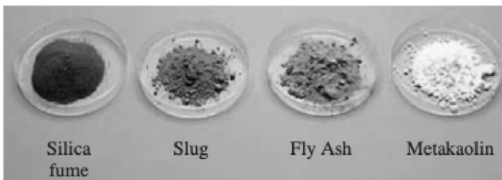
**Figura 2.9 Ejemplos de aditivos minerales.**
