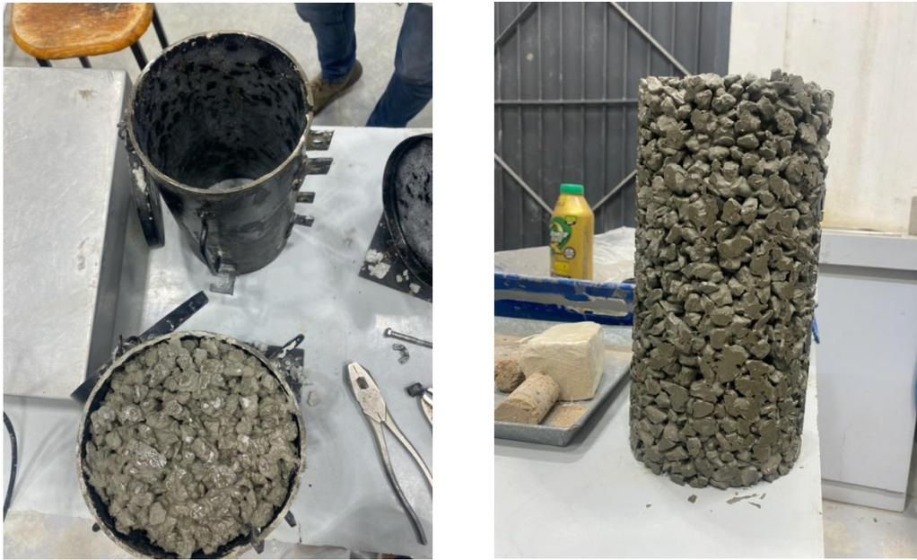
***Figura 3.6 Izquierda – Desmolde de cilindro de concreto permeable.
