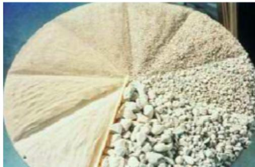
**Figura 2.2 Varios tamaños de partículas que se encuentran en los agregados para uso en concreto.**
