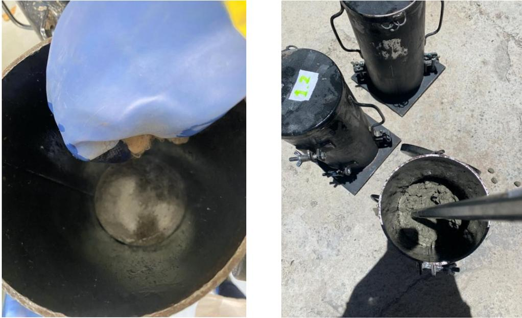
*Figura 3.5 Izquierda – Aplicación de desmoldante en cilindro metálico
