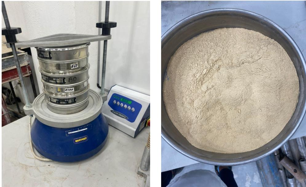
**Figura 3.1** Proceso de tamizado por medios mecánicos de residuo minero
