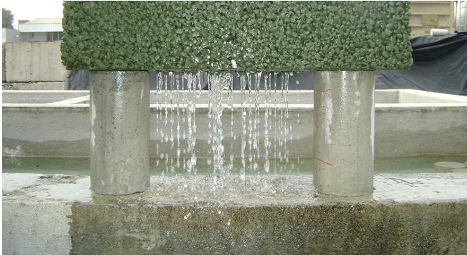
**Figura 2.5 Prueba de permeabilidad concreto permeable**
