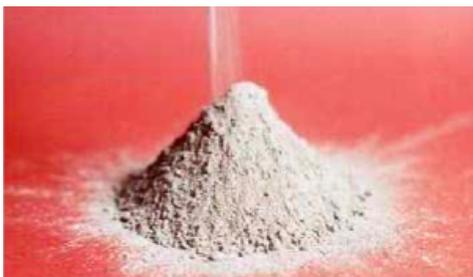
**Figura 2.3 El cemento Portland es un polvo fino que cuando se mezcla con el agua se convierte en un pegamento que mantiene los agregados unidos en el concreto.**
