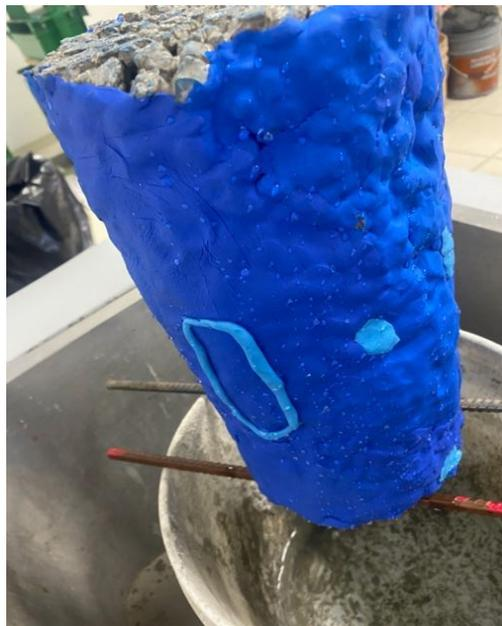
**Figura 3.8 Prueba de permeabilidad en cada cilindro**
