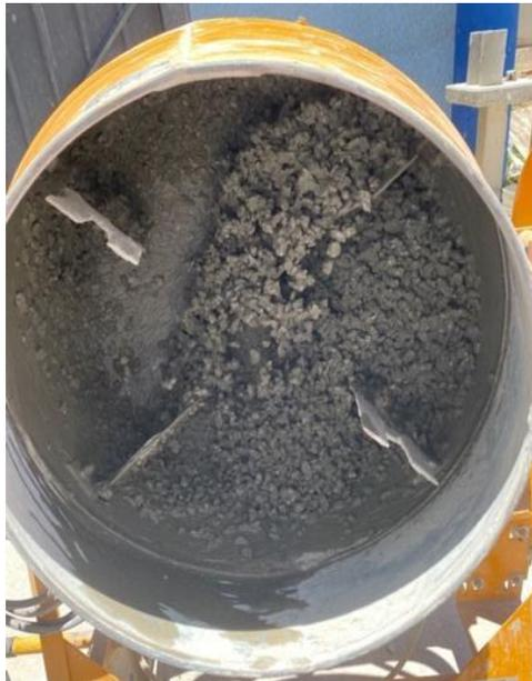
***Figura 3.4 Mezcla de materiales en revolvedora***
