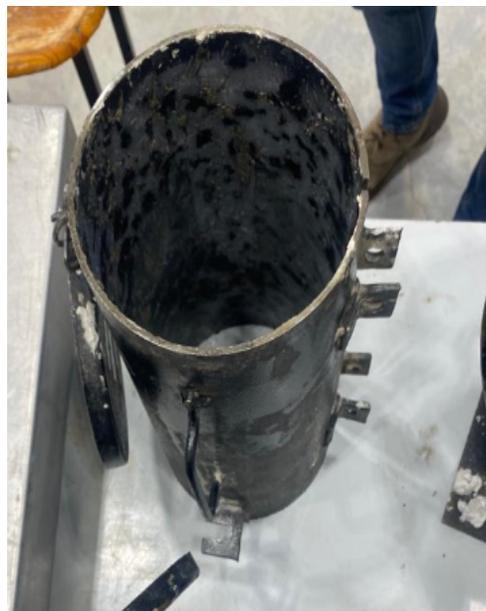
**Figura 3.2** Molde para cilindros
