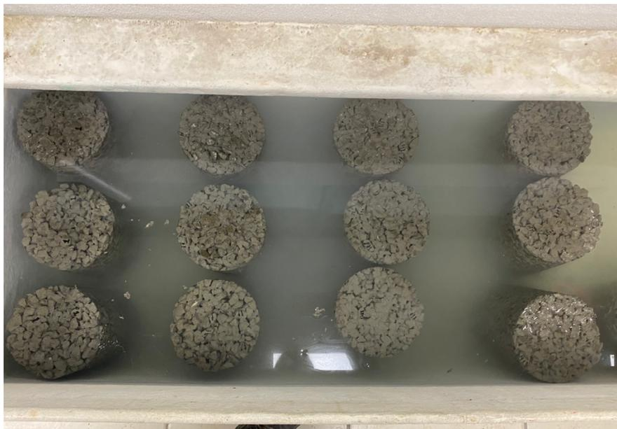
***Figura 3.7 Proceso de curado por inmersión – Cilindros de concreto permeable***
