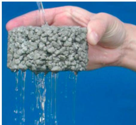
**Figura 2.4** *Espécimen de concreto permeable.*
