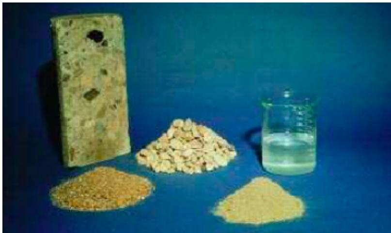
**Figura 2.1 Componentes del concreto: cemento, agua, agregado fino, agregado grueso, son combinados para formar el concreto.**
