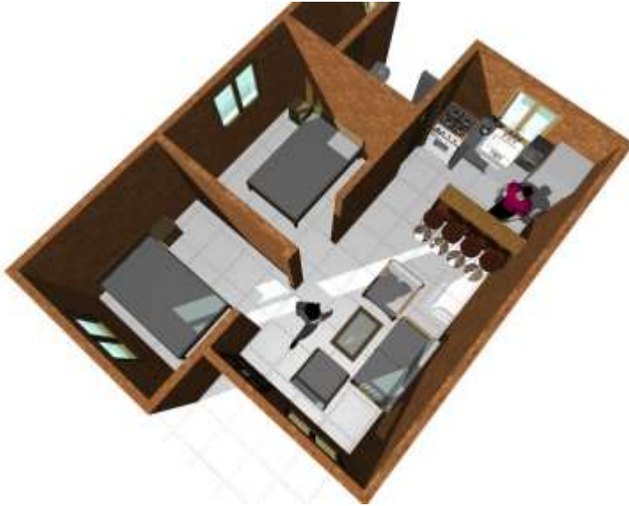
Ilustración 59: modelo de vivienda estandar, se observa cambio de mobiliario tipo, circulaciones cruzadas y falta de privacidad en area de baño, Casa Geo, 2012
