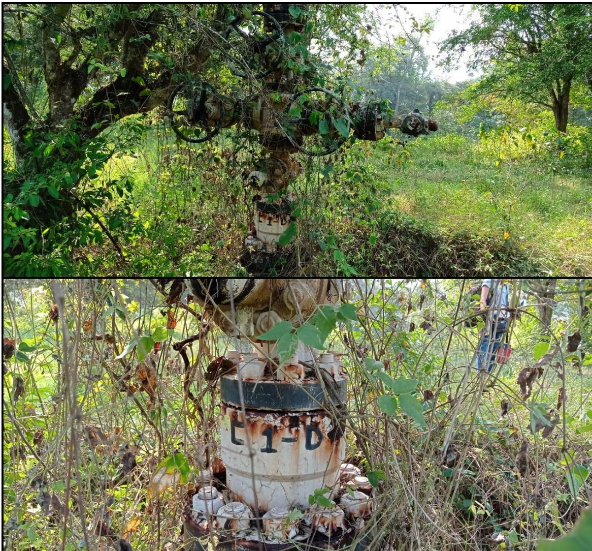
Figura 14 Imágenes tomadas en el campo Candelaria. Arriba: Árbol de válvulas Candelaria 1-D. Abajo: Acercamiento a las siglas “C 1-D” que identifican a la perforación. Fotografías tomadas por Ballato-González (2022).
