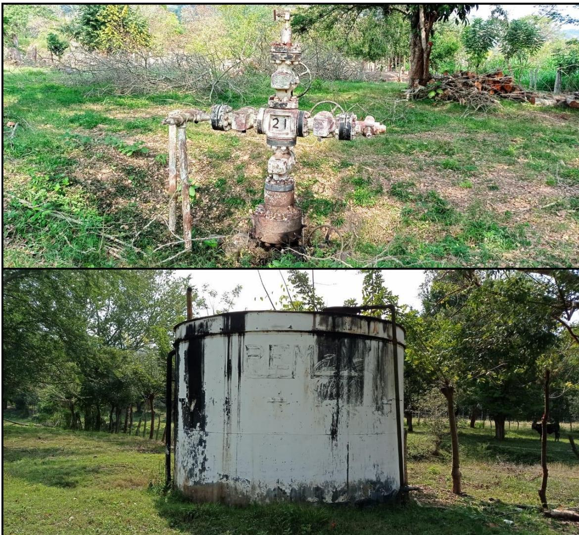
Figura 13 Imágenes tomadas en el campo Candelaria. Arriba: Árbol de válvulas de Candelaria 21. Abajo: Tanque de almacenamiento ubicado a un par de metros del árbol de válvulas Candelaria 21. Fotografías tomadas por Ballato-González (2022).
