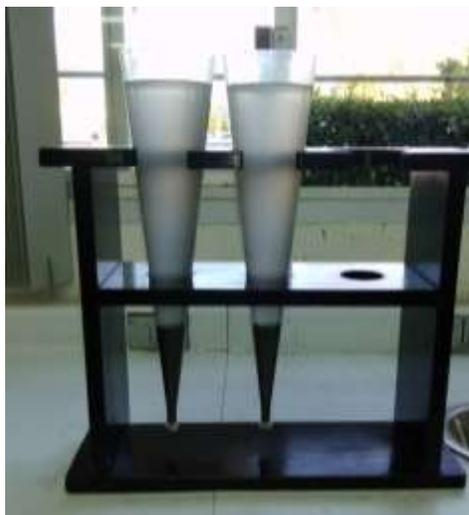
**Figura 100.** Determinación de sólidos sedimentables mediante conos Imhoff.
