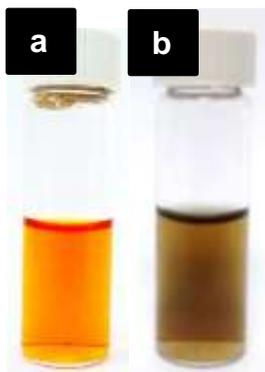
**Figura 68.** a) Solución inicial de **poli(*p*-ABz) mod *p*-AAFS-Pd(OAc)<sub>2</sub>** b) solución de **poli(*p*-ABz) mod *p*-AAFS-Pd(OAc)<sub>2</sub>** después de adicionar  $\text{NaBH}_4$  ( $t= 30\text{s}$ ).
