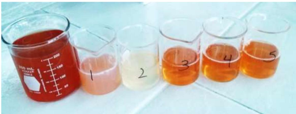
**Figura 98.** Aspecto de los efluentes con colorantes tipo naftol; de izquierda a derecha, agua residual, aguas tratadas por coagulación-floculación provenientes de las jarras 1, 2, 3, 4 y 5.
