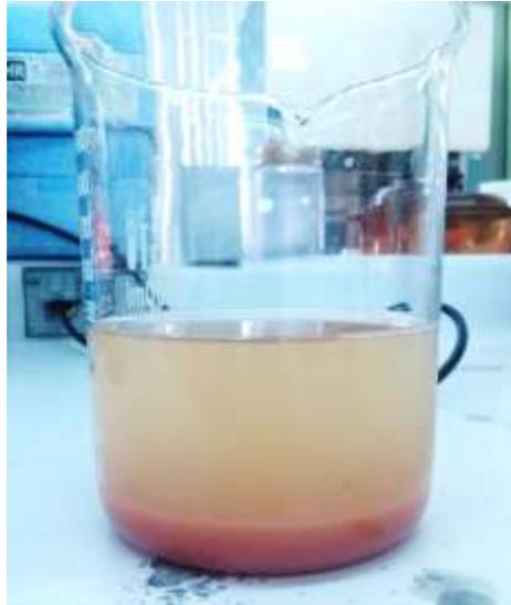
**Figura 99.** Aspecto de la jarra conteniendo agua residual con naftoles después del tratamiento con clurón/ poli(*p*-ABz) mod *p*-AAFS.
