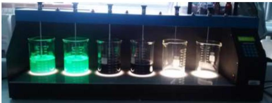
**Figura 78.** Prueba de jarras para los efluentes con colorantes reactivo (verde) y cuba (azul).
