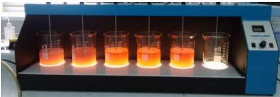
**Figura 79.** Prueba de jarras para efluentes con colorantes de tipo naftol.
