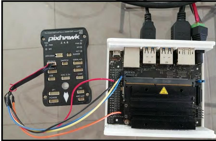
Figura 5.21: Conexión física de la plataforma.
