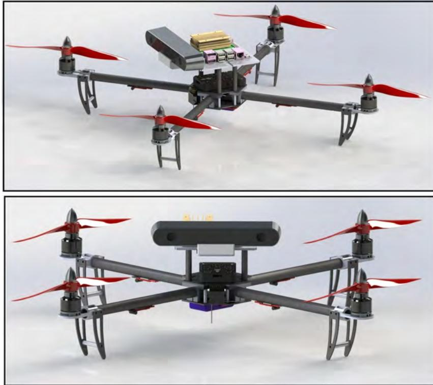
Figura 4.2: Modelo CAD de la plataforma experimental en Solid Works. Vistas superior (arriba) y frontal (abajo).
