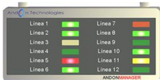
Figura No. 27 Ejemplo de estado de líneas en ANDON. Fuente: Tomada de www.andontechnologies.com
