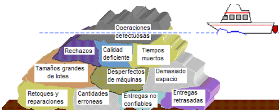
Figura No. 22 Se muestra como los problemas se descubren al eliminar inventarios innecesarios. Fuente: Elaboración propia.
