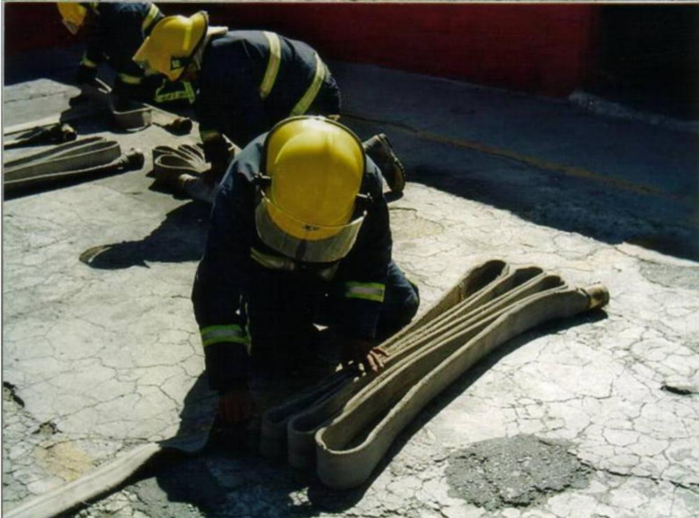
Foto 9. Recogimiento de manguera después de terminada la contingencia, paso 1
