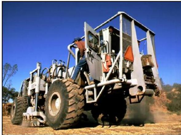
Figura 3. Camión Vibroseis
