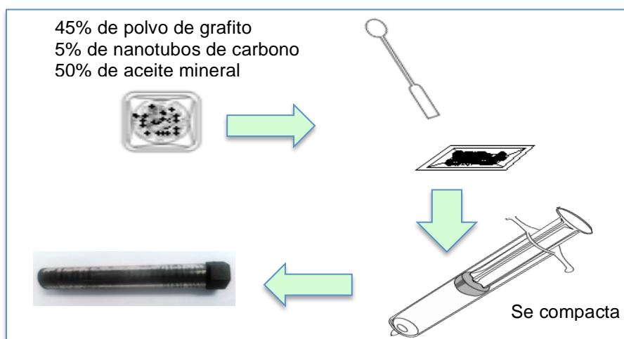
Figura 9. Construcción del electrodo composite
