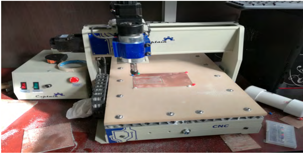
Figura 2.22: Grabado y corte de PCB por CNC.
