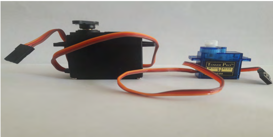
Figura 2.15: (Izquierda) Servomotor de 15 Kg con engranaje metálico, (Derecha) Servomotor de 2.5 Kg con engranaje de plástico.
