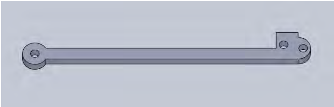
Figura 4.9: Primera pieza en CAD del cúbito y radio en el robot.
