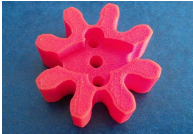
Figura 4.23: Pieza impresa correspondiente al engrane diseñado.
