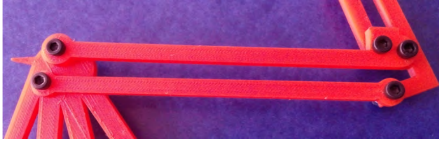
Figura 4.13: Piezas impresas correspondientes al cúbito y radio en el ensamblaje físico del robot.
