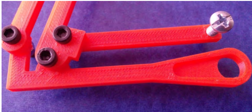
Figura 4.7: Piezas impresas correspondientes al húmero en el ensamblaje físico del robot.
