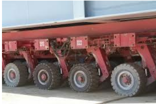
Figura 2: Configuración de cuatro módulos de carga.
