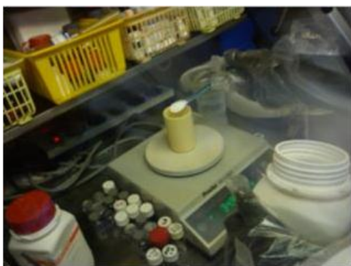
Figura 4.9. A) Pesada de la mezcla salina. B) Introducción del crisol en la celda
