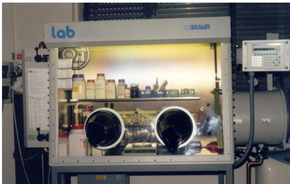
Figura 4.1. Caja de guantes mBraun Labstar 50
