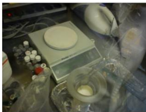
Figura 4.9. A) Pesada de la mezcla salina. B) Introducción del crisol en la celda
