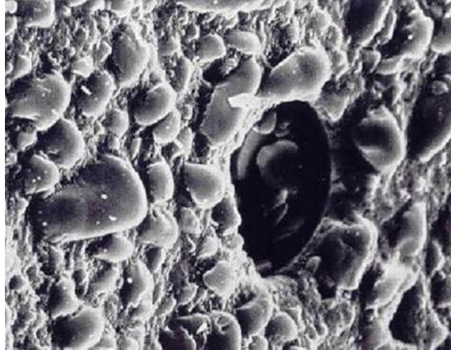
Figura 18 Cráter formado por el desprendimiento de una partícula de macrorrelleno
