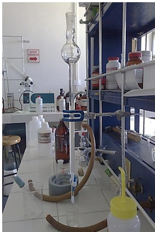
Figura 27 Purificación del 1,4FBAC mediante cromatografía en columna
