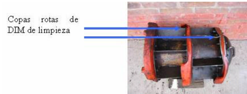
Figura 3.6 Copas rotas de DIM de limpieza. Fuente: Imagen tomada en la corrida de DIM el día 10 de abril del año 2006
