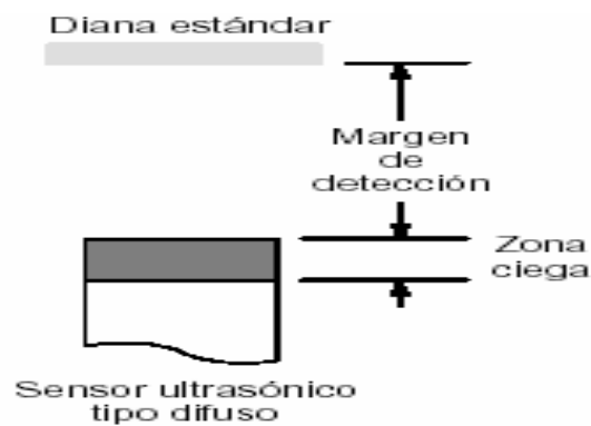
Figura 5.7 Zona ciega y margen de detección. Fuente: http://www.pepperl-fuchs.com
