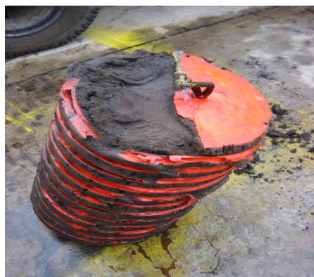
Figura 3.4 DIM destruido por defectos de fabricación. Fuente: Imagen tomada en la corrida de DIM el día 24 de junio del año 2006
