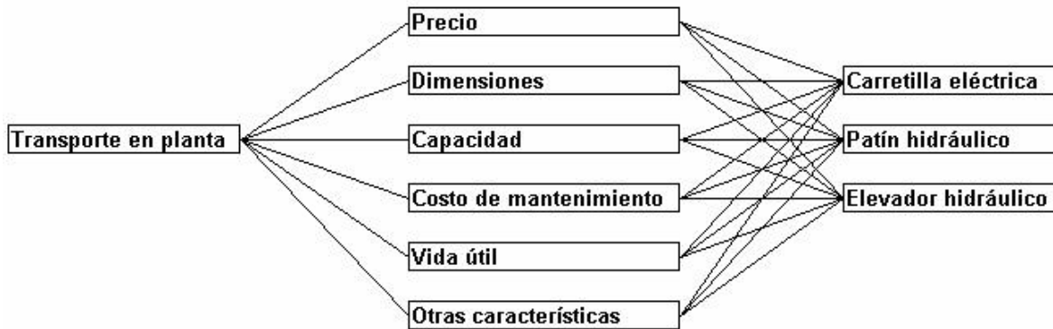
Figura 61. Modelo derivado de la lluvia de ideas para transporte de producto terminado en la planta
