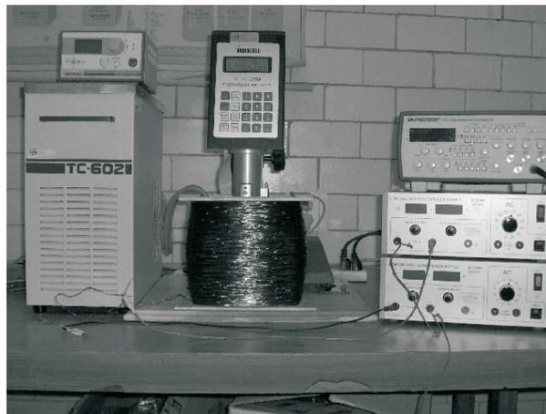
Figura 2.11: Sistema de reometría con campo magnético. Se muestra el solenoide y el reómetro acoplados. También se muestra el baño térmico y las fuentes de voltaje.
