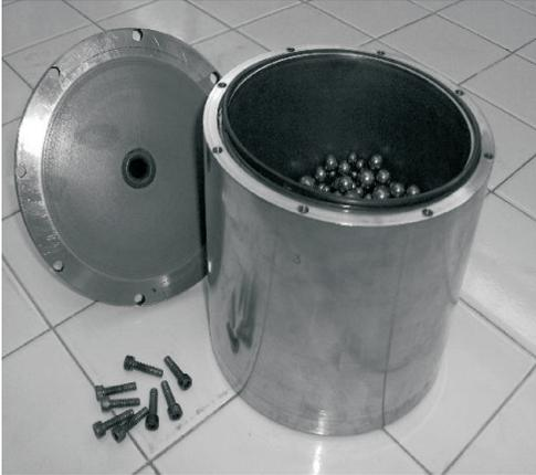
Figura 3.1: Detalle del cilindro donde se vierte el material a moler. También se observan los balines.
