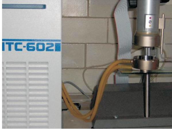
Figura 2.6: Detalle del baño térmico y el plato del reómetro.
