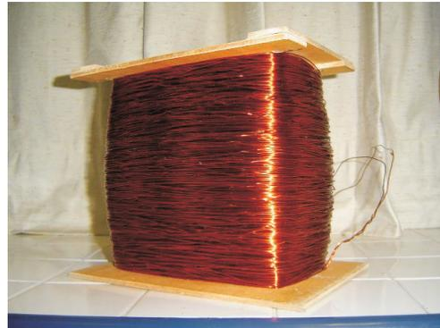
Figura 2.8: Fotografía del solenoide construido.
