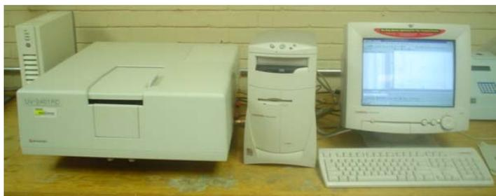
**Figura 21.** Espectrofotómetro UV-Vis “SHIMADZU 2401PC”.
