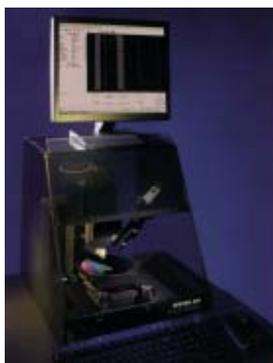
Figura 33. Perfilómetro VEECO DEKTAK 6M.
