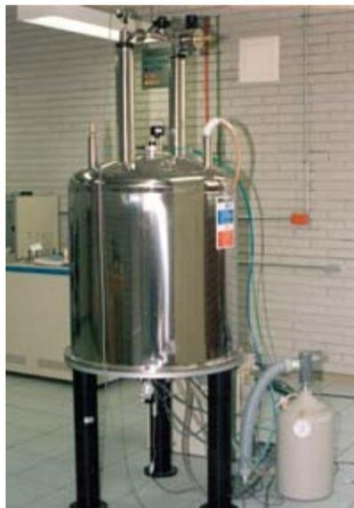
**Figura 19.** Equipo de Resonancia Magnética Nuclear “JEOL” de 300 MHz.
